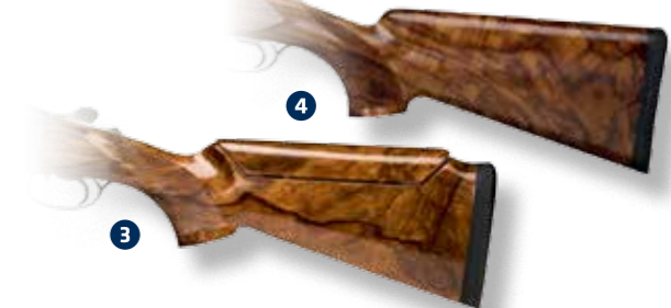
Hinterschaft „Sporting“: verstellbar, vertikal (14 mm), horizontal (10 mm) Länge: 365 mm, Senkung: 40 mm/58 mm/70 mm (Abb. 3) Schaftmaße für den englischen Markt: Länge: 365 mm, Senkung: 38 mm/50 mm/60 mm
